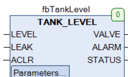
Рис. 5.27. Внешний вид ФБ TANK_LEVEL на языке CFC
