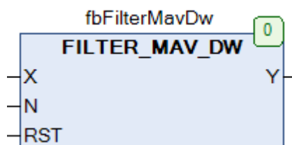
Рис. 19.20. Внешний вид ФБ FILTER_MAV_DW на языке CFC
