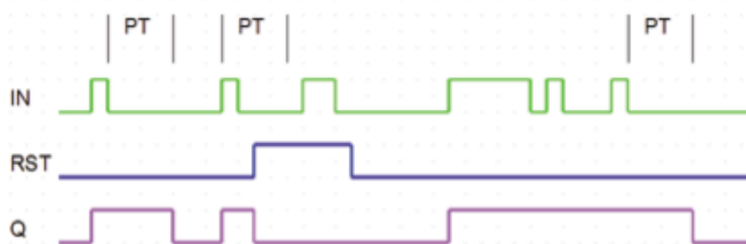
Рис. 15.37. Трассировка работы ФБ TOF_1
