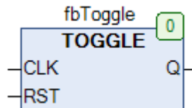
Рис. 17.20. Внешний вид ФБ TOGGLE на языке CFC
