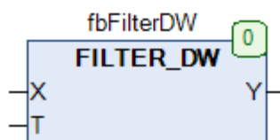
Рис. 19.17. Внешний вид ФБ FILTER_DW на языке CFC
