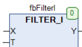
Рис. 19.19. Внешний вид ФБ FILTER_I на языке CFC
