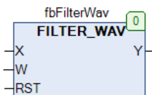
Рис. 19.26. Внешний вид ФБ FILTER_WAV на языке CFC
