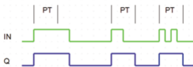
Рис. 15.35. Трассировка работы ФБ TMIN
