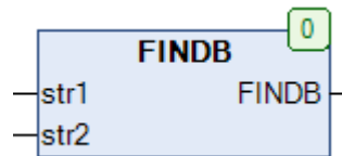
Рис. 13.51. Внешний вид функции FINDB на языке CFC
