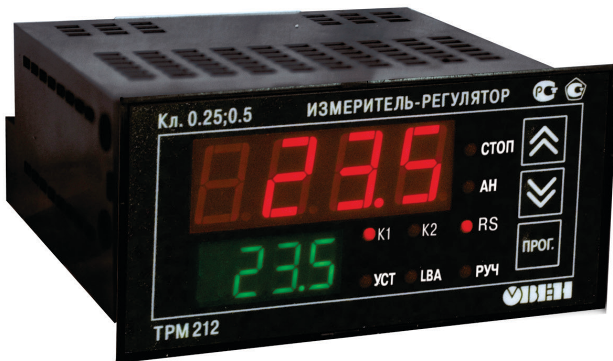
Рис. 4.6. Отображение измеренного значения 1-го канала TRM212 и уставки его регулятора в CODESYS и на индикаторах TPM
