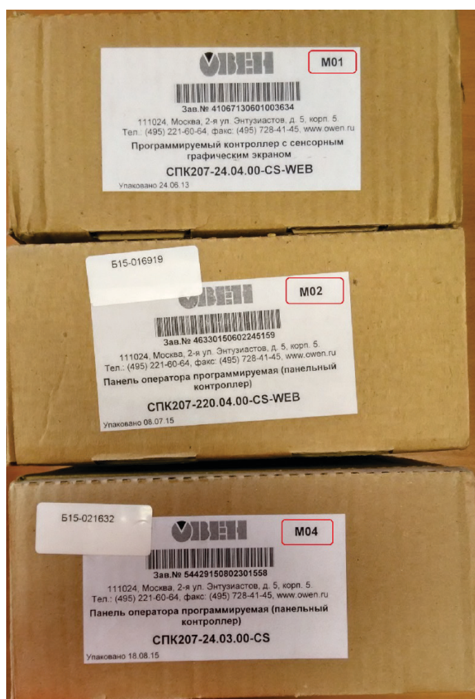
Рис. 6.1. Модификация контроллера указана на коробке с прибором
