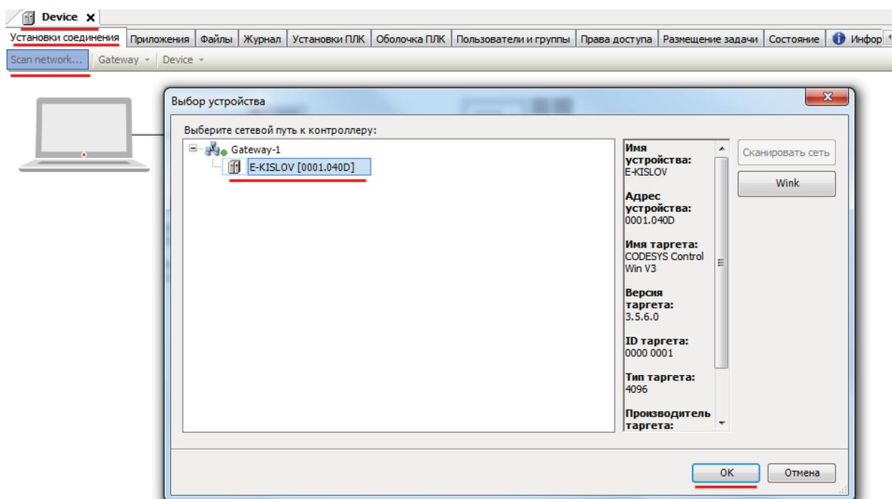
Рис. 7.19. Установка связи с виртуальным контроллером
