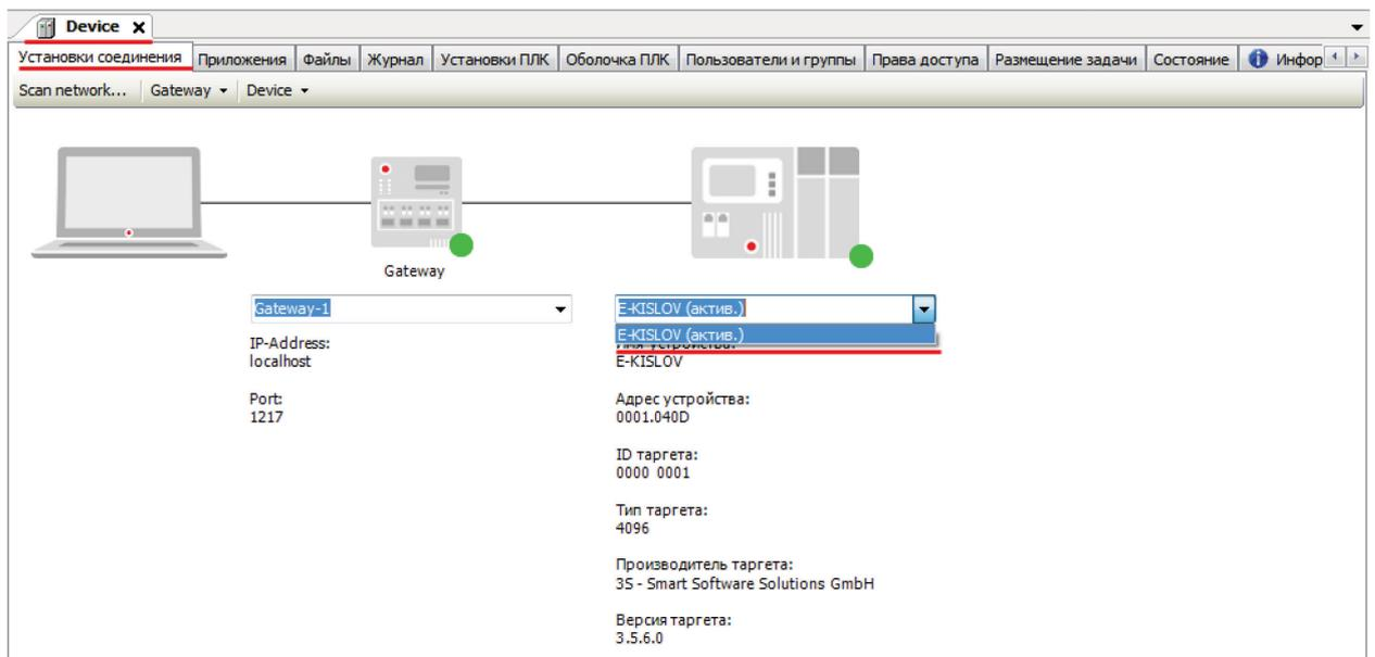
Рис. 7.20. Установка связи с контроллером в CODESYS. Связь установлена
