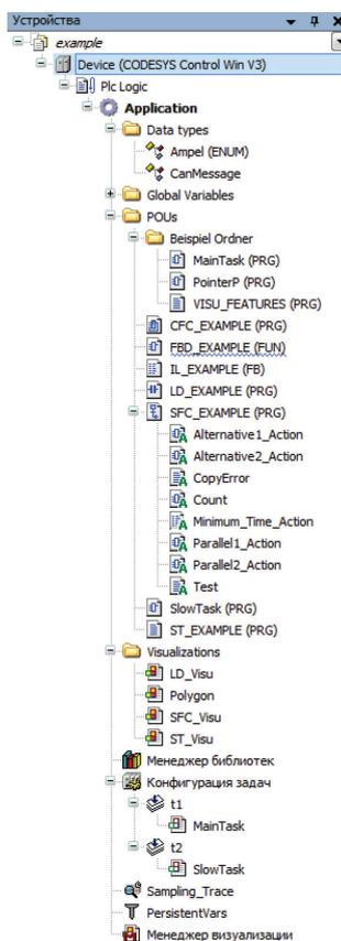
Рис. 7.13. **Панель устройств CODESYS V3.5 SP6** (проект example)
