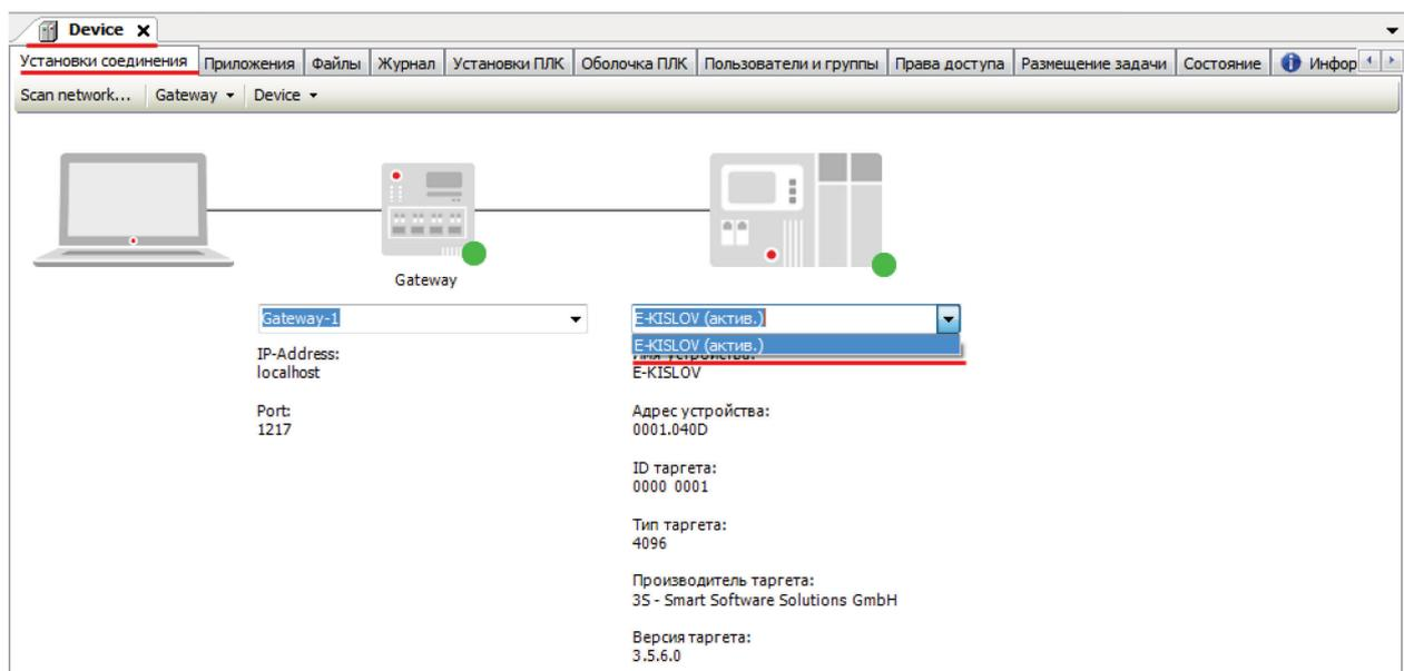
Рис. 7.30. Установка связи с контроллером в CODESYS. Связь установлена
