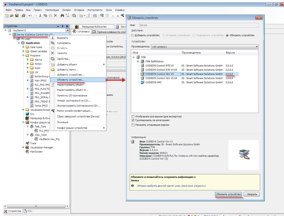
Рис. 7.37. Обновление target-файла
