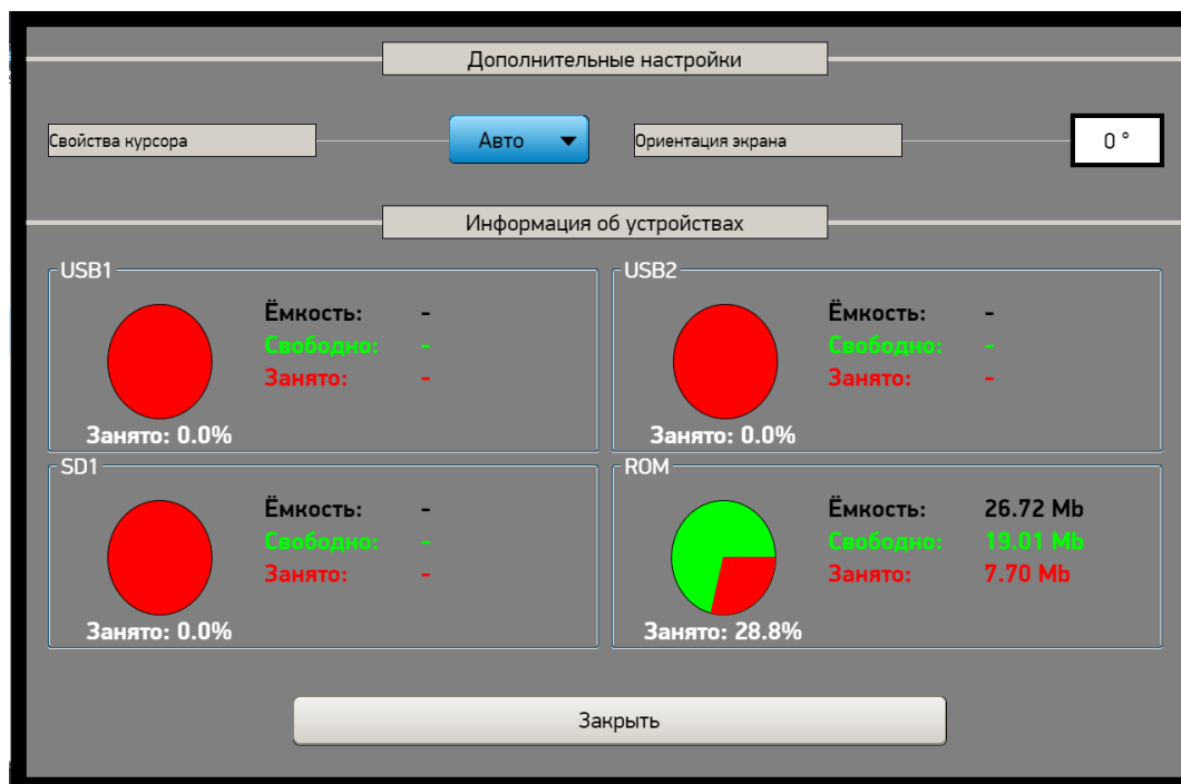
Рис. 2.1. Информация о памяти контроллера и накопителей в конфигураторе СПК
