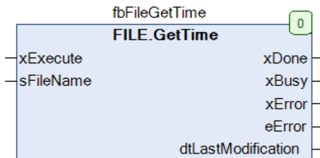
Рис. 3.20. Внешний вид ФБ FILE.GetTime на языке CFC
