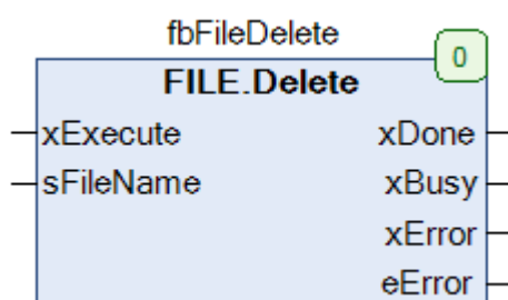
Рис. 3.14. Внешний вид ФБ FILE.Delete на языке CFC
