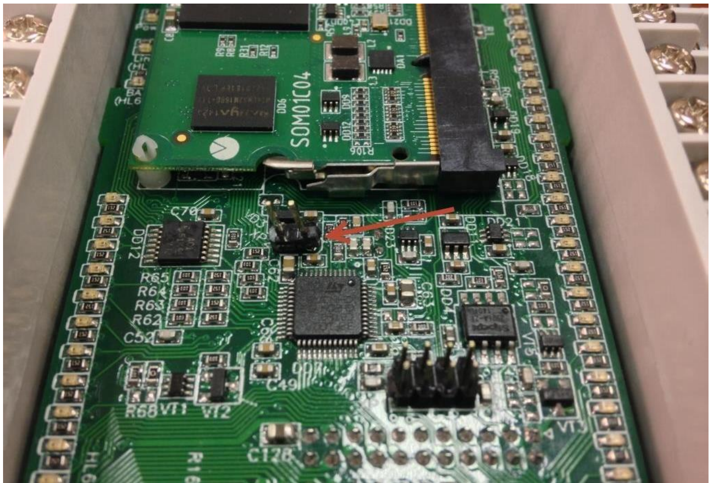
Рисунок 2.26. Перемычка XP2 для ПЛК110-60 [M02]
