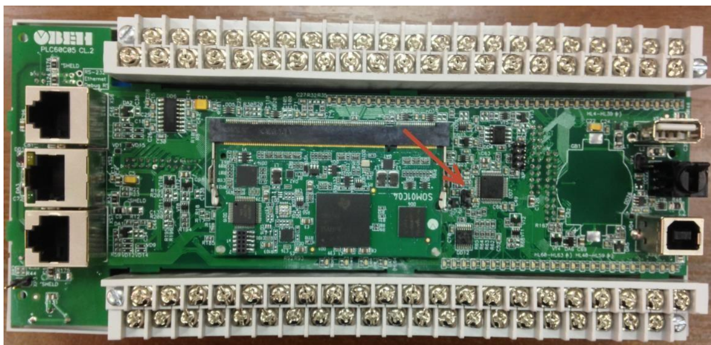
Рисунок 2.2а. Верхняя плата контроллера ПЛК110-60 [М02]
