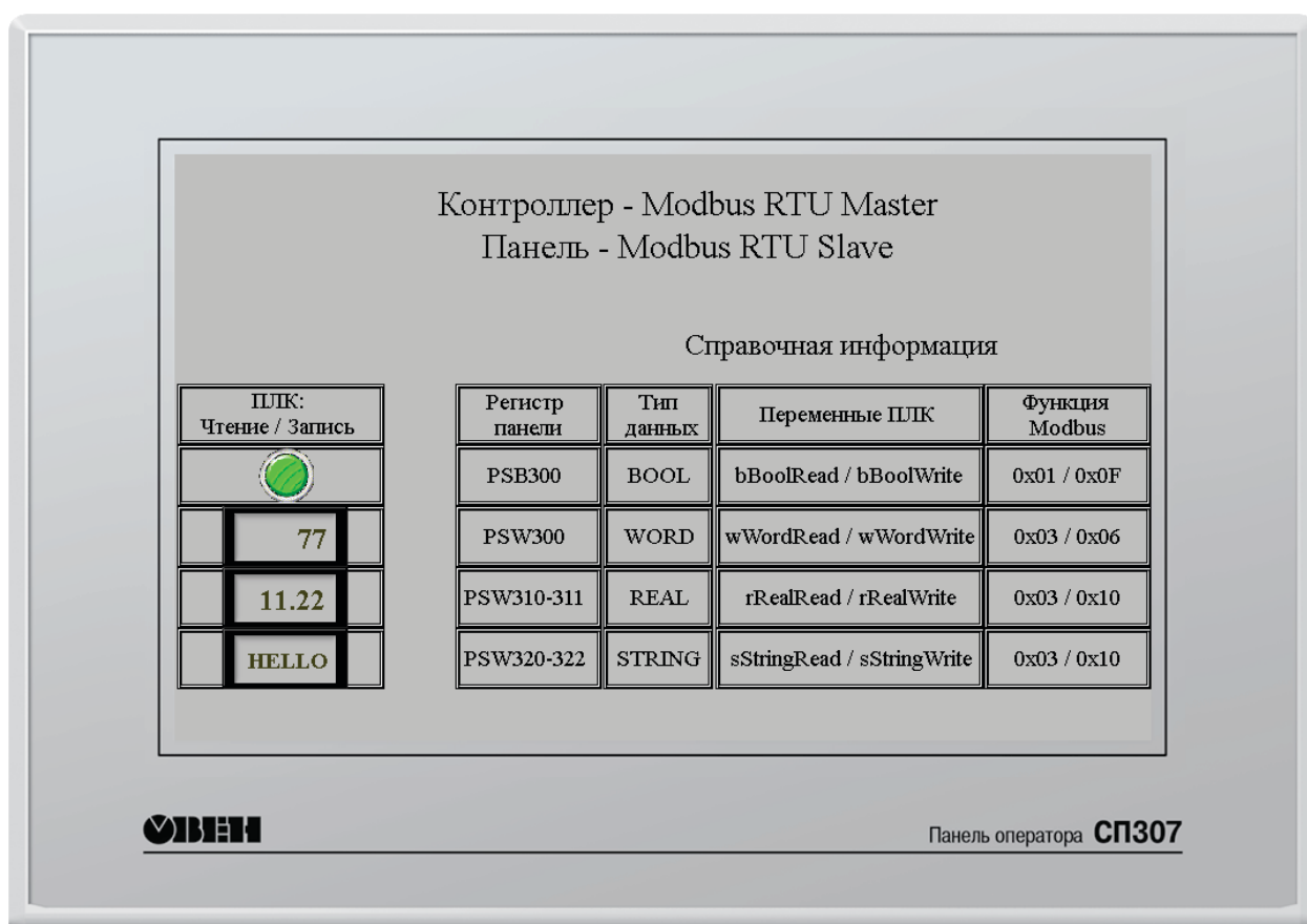
Рис. 40. Ввод значений с помощью сенсорного дисплея панели
