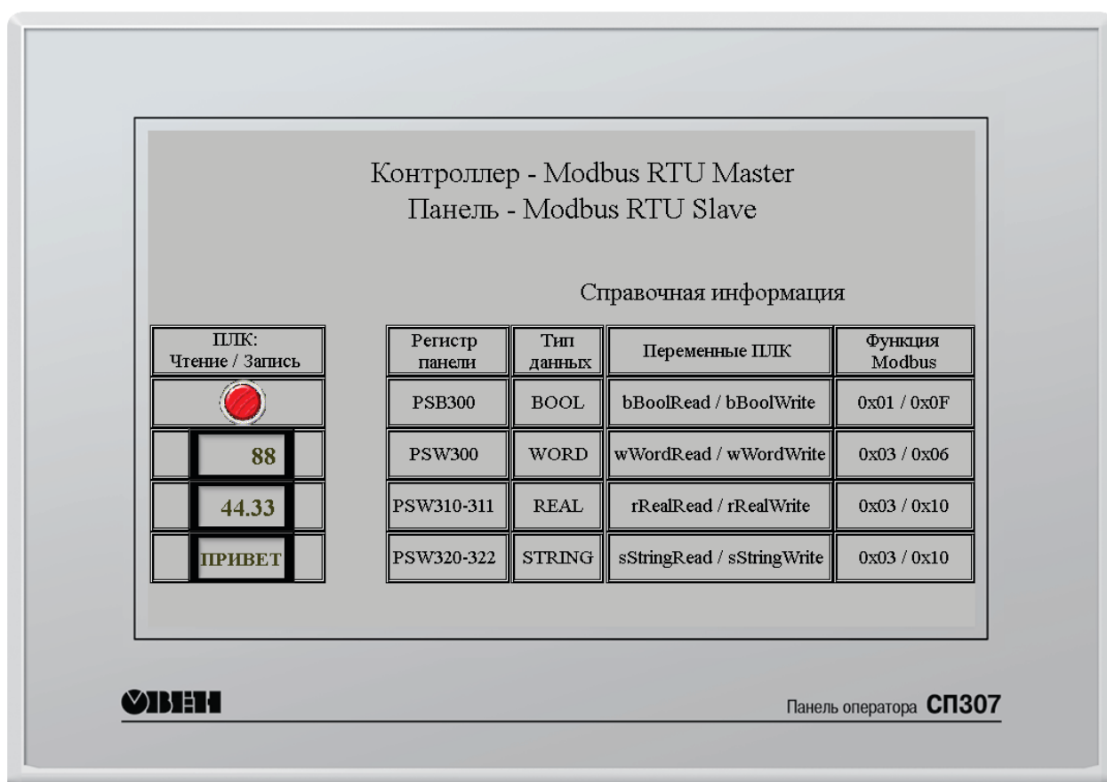
Рис. 43. Отображение введенных в CoDeSys значений на панели
